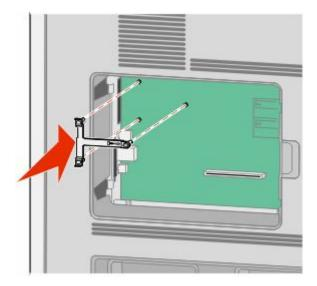
**6** Installare la porta ISP sul giunto a T di plastica. Angolare la porta ISP sul giunto a T di plastica, quindi avvicinare il giunto a T di plastica in modo che qualsiasi connettore sospeso passi attraverso l'apertura della porta ISP nell'alloggiamento della scheda di sistema.
