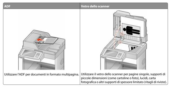
Lo scanner consente di effettuare la scansione di documenti direttamente su un computer o un'unità Flash. La ricezione di immagini inviate tramite tale funzione non richiede il collegamento diretto del computer in uso alla stampante. È possibile eseguire di nuovo la scansione del documento sul computer nella rete creando un profilo di scansione sul computer e quindi scaricando il profilo sulla stampante.
