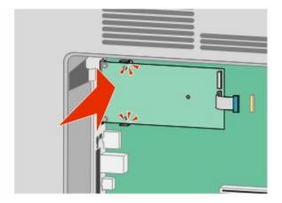
Inserire la vite a testa piatta lunga e ruotarla in senso orario in modo da tenere la porta ISP in posizione, ma non serrare la vite in questo momento.
