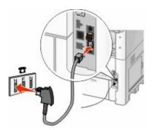
**4** Per utilizzare la stessa linea sia per la comunicazione fax che telefonica, collegare una seconda linea telefonica (non fornita) tra il telefono e lo slot F di una presa a muro telefonica funzionante.
