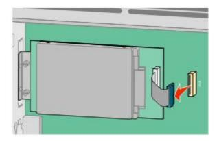
**b** Rimuovere le viti che tengono il disco fisso della stampante in posizione.
