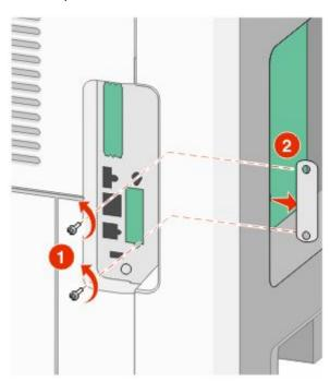
4 Inserire una scheda fax e stringere le due viti fornite per fissare la staffa di montaggio della scheda fax.
