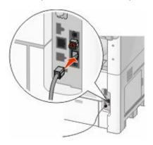
**3** Collegare l'altra estremità del cavo telefonico allo slot N di una presa a muro telefonica funzionante.
