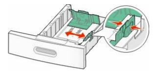
3 Sbloccare la guida della lunghezza, premere contemporaneamente la linguetta della guida della lunghezza verso l'interno come mostrato in figura e spostare la guida nella posizione adeguata alle dimensioni delle carta caricata.
