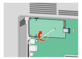
**9** Serrare le due viti fornite per fissare la staffa di montaggio della porta ISP all'alloggiamento della scheda di sistema.
