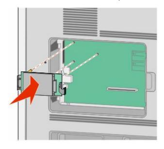
**b** Stringere le due viti fornite per fissare la staffa di montaggio del disco fisso della stampante.
