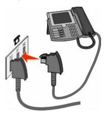
**5** Per utilizzare la stessa linea per la registrazione dei messaggi nella segreteria telefonica, collegare una seconda linea telefonica (non fornita) tra la segreteria telefonica e l'altro slot N della presa a muro telefonica funzionante.
